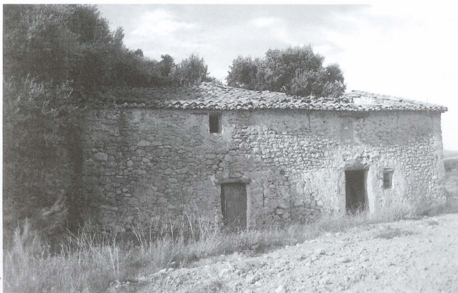
Imatge d'un habitatge dispers a Banyeres, tipus AR-H-R-Ca. Dos crugies paral·leles a la façana.
