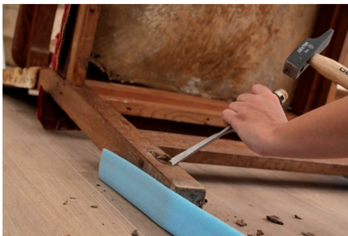
Fig. 39. Detalle proceso de eliminación astillado de la espiga rota. Foto: Elisa Martínez Zerón.
