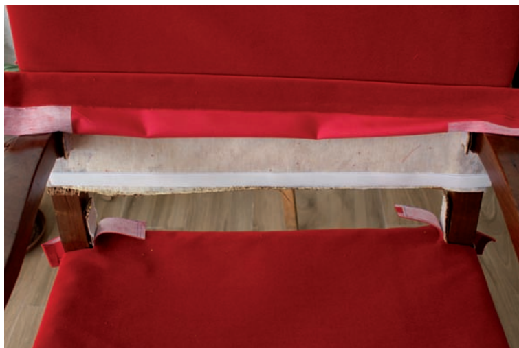
Fig. 46. Resultado del entelado de las zonas de corte directo en el tapizado. Foto: Elisa Martínez Zerón.
