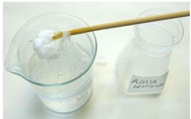
Fig. 8: precipitado blanco y elástico producido por la interacción entre agua y Paraloid B-72®.
