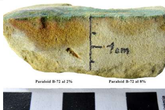
Fig.2: grado de penetración de Paraloid B-72® al 2% de concentración (izquierda) y al 8% de concentración (derecha).
