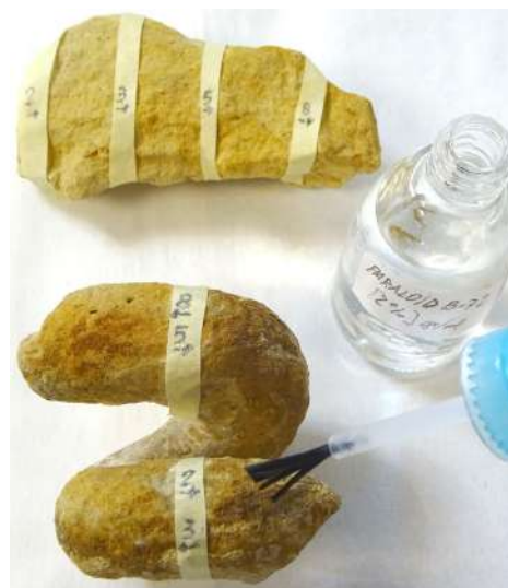
Fig. 12: pruebas de consolidación en ejemplar del icnogénero Gyrolites y su matriz a diferentes concentraciones de Paraloid B-72®.
