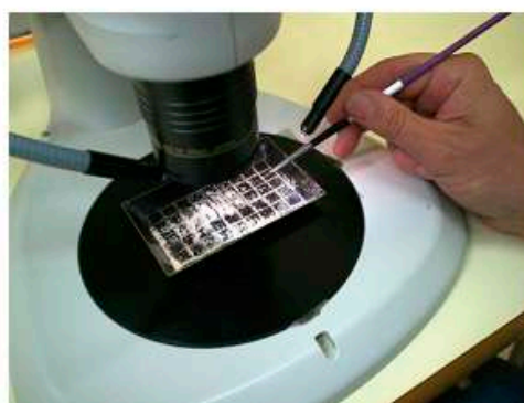
Fig. 7: diferentes imágenes que ilustran el proceso del levigado, técnica micropaleontológica empleada en este trabajo para la obtención de microfósiles.
