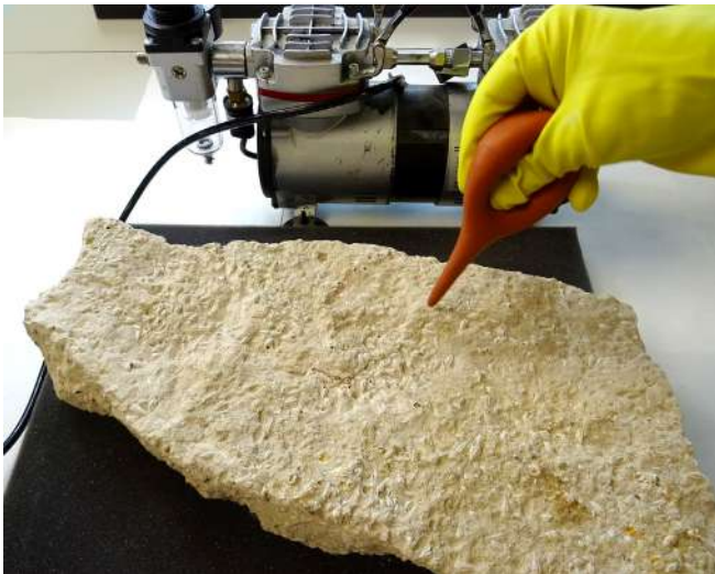
Fig. 7: limpieza superficial del ejemplar con pera de goma.
