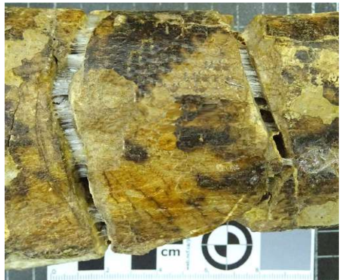
Fig. 5: efectos de la superación de la temperatura de ablandamiento en nitrato de celulosa usado como adhesivo hace 35 años sobre un resto fósil de mamífero. En la actualidad no se recomienda el uso de nitrato de celulosa como adhesivo definitivo (pegamento Imedio®).
