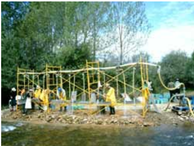
Fig. 5: La técnica del lavado-tamizado en el río Alarzón. Campaña de Atapuerca 2008. La motobomba se encuentra a la derecha. Cada par de mangueras que salen del tubo distribuidor horizontal sirve para procesar una muestra, por lo que se pueden procesar 9 muestras a la vez.
