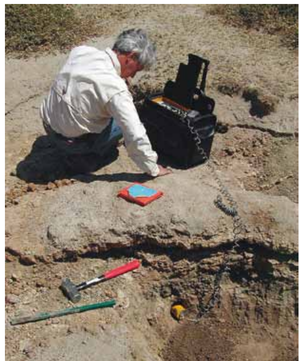
Fig. 14: para obtener edades mediante termoluminiscencia o Luminiscencia óptica es necesario medir previamente la radiactividad del sedimento. En este caso el especialista canadiense Jack Rink toma medidas en sedimentos del Pleistoceno Superior del lago Eyasi (Tanzania).
