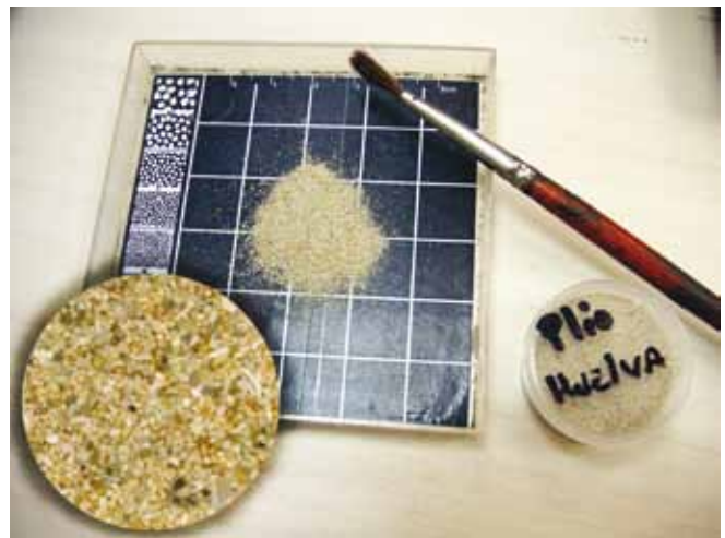
Fig. 9: levigado de una muestra de arena del Plioceno de Huelva una vez lavada y tamizada.
