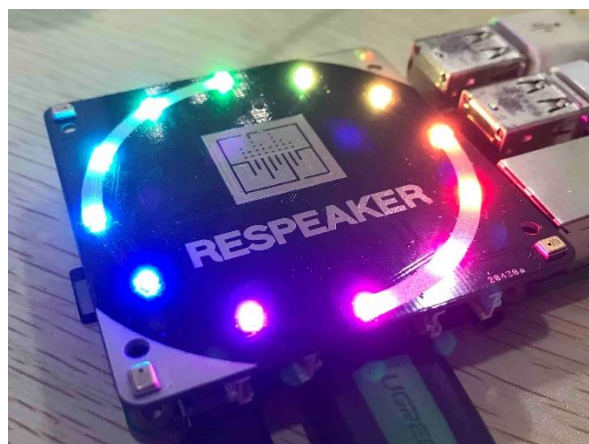
Figura 42. Detalle de funcionamiento de los leds de la placa ReSpeaker 4-MIC. FUENTE: wiki.seeedstudio.com/ReSpeaker_4_Mic_Array_for_Raspberry_Pi/ .
