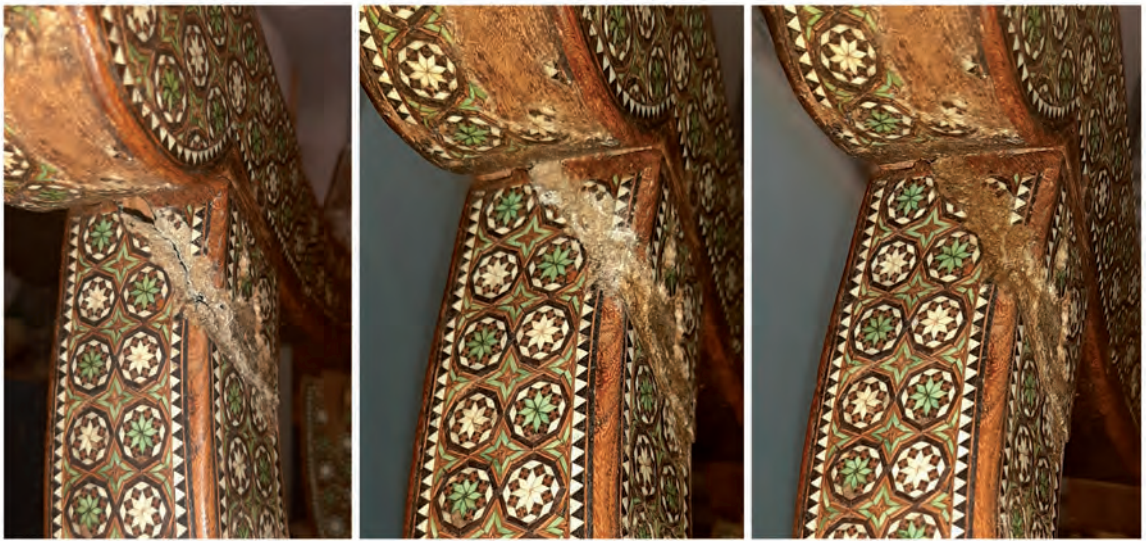
Fig. 30. Fractura original, reintegración material y reintegración cromática en la Jamuga 2 . Foto: Marina Albaladejo Cerezo
