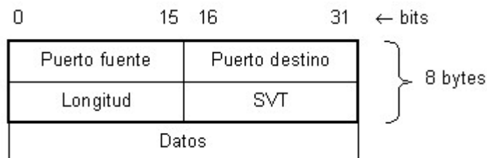
Figura 4. Formato de una estructura de datos UDP.
