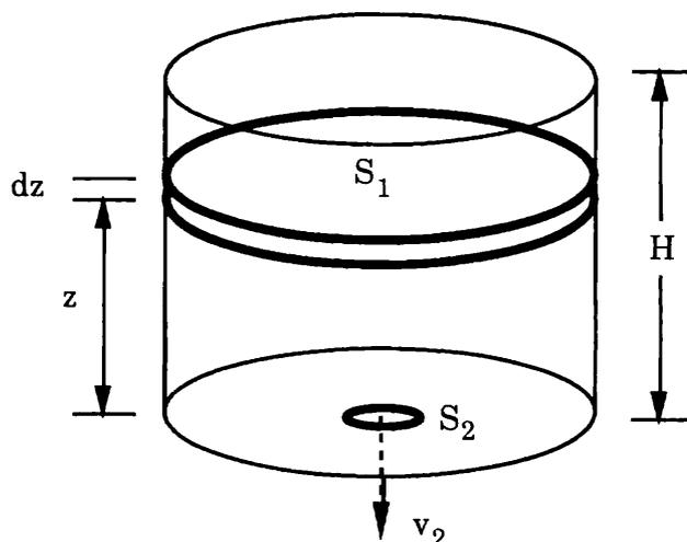
Si la sección del orificio es  $S_2$  y la de la superficie libre del depósito  $S_1$ , al descender el nivel en una cantidad  $dz$  en un intervalo de tiempo  $dt$ , el gasto  $Q$  que sale por el orificio será:
