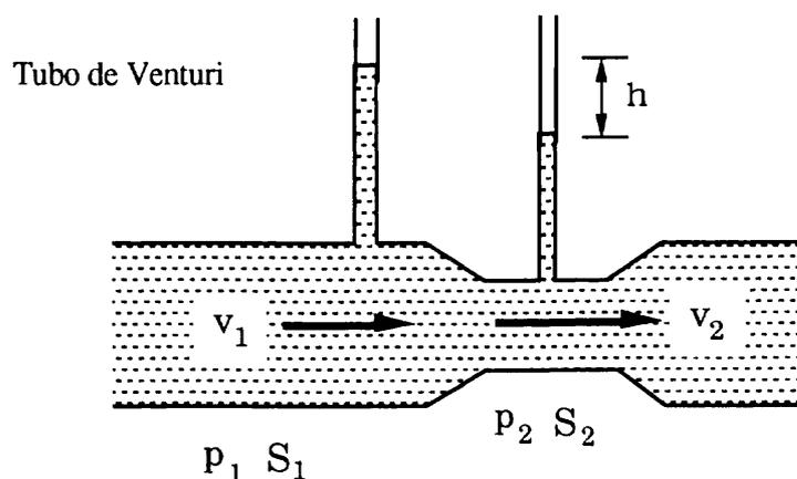
Aplicando el Teorema de Bernoulli a los puntos 1 y 2, el primero en la parte ancha de sección  $S_1$ , velocidad  $v_1$  y presión  $p_1$ , y el segundo en el estrechamiento, con sección  $S_2$ , velocidad  $v_2$  y presión  $p_2$ , teniendo en cuenta que  $z_1 = z_2$ :
