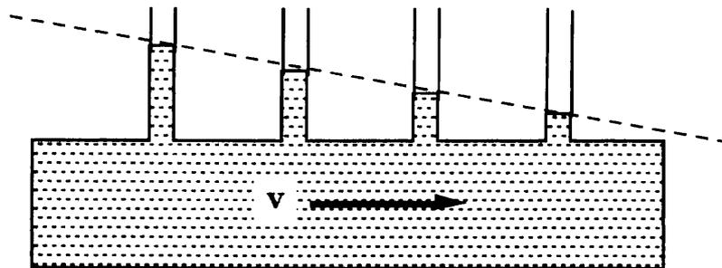
Pérdida de carga de un fluido real por una tubería de
