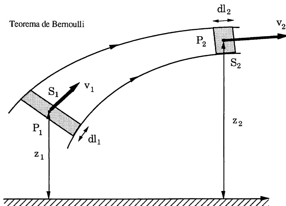
Vamos a aplicar el principio de conservación de la energía a los dos puntos 1 y 2 del fluido, recordando que la variación de la energía (cinética y potencial) es igual al trabajo de las fuerzas exteriores. Calculemos este trabajo así como las variaciones en la energía cinética y potencial.
