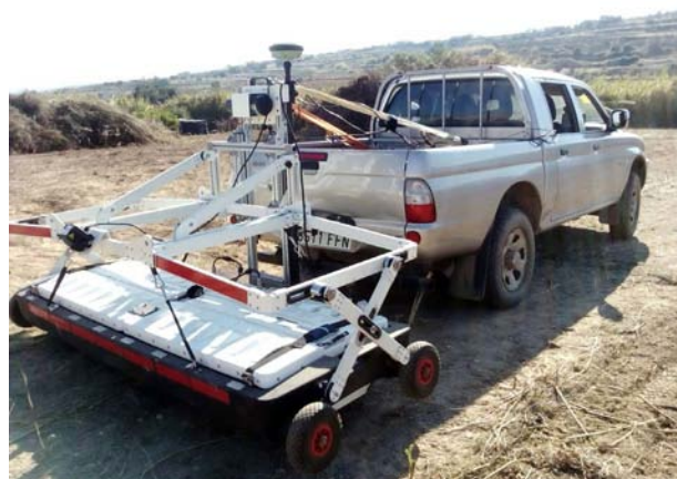
FIGURA 2. Imagen del georradar durante las tareas de prospección geofísica en La Rana.
