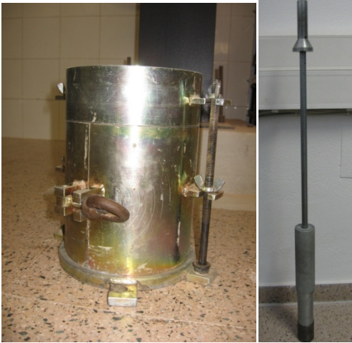
Pisón y molde para ensayo Próctor
