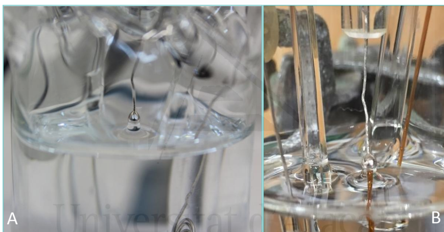
Figura 2-32. Configuraciones de menisco colgante en una célula electroquímica mediante la técnica de “ dipping ” 28 empleadas durante esta tesis. A) Disposición en una celda electroquímica estándar. B) Celda de impinging jet flow con capilares de sílice
