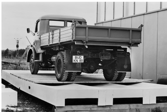
25. ENSAYO DE CARGA DE TRES PIEZAS
