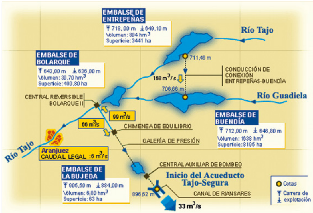
Figura 3. Central reversible de Bolarque y su conexión con el TTS.
