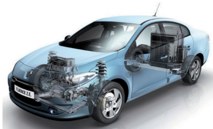
Fig. 5: Disposición del motor eléctrico y la batería de tracción en el Renault Fluence Z.E.
