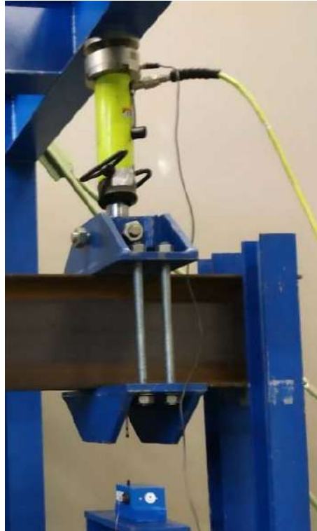
Figura 10. Detalle mostrando la posición del sensor de hilo y el conjunto del pistón y la célula de carga.
