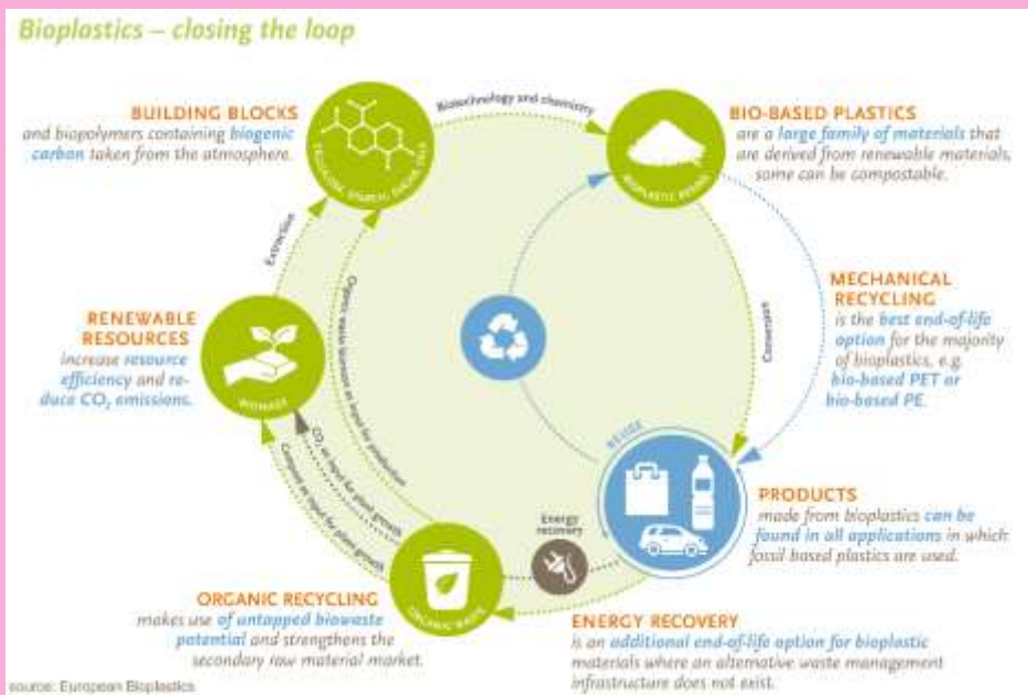
Figura 1. Esquema de las opciones de fin de vida útil de los bioplásticos. Imagen obtenida de European bioplastics.
