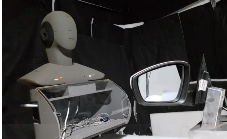
Figura 24. Montaje del equipo de medida en cámara semianecoica.
