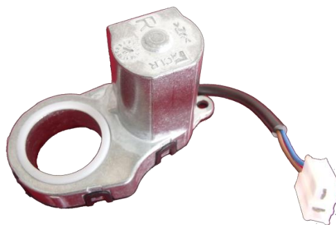
Figura 8. Reductor empleado para el abatimiento de espejos retrovisores de vehículos.
