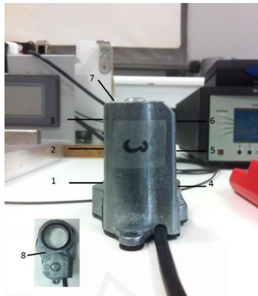
Figura 41. Posiciones de medida en reductor.
