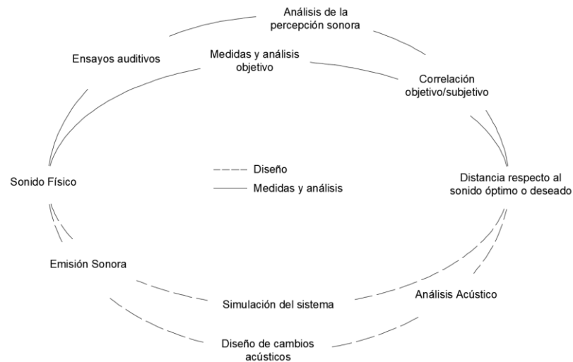
Figura 5. Diagrama de optimización de la calidad acústica de un producto según Fog [41].
