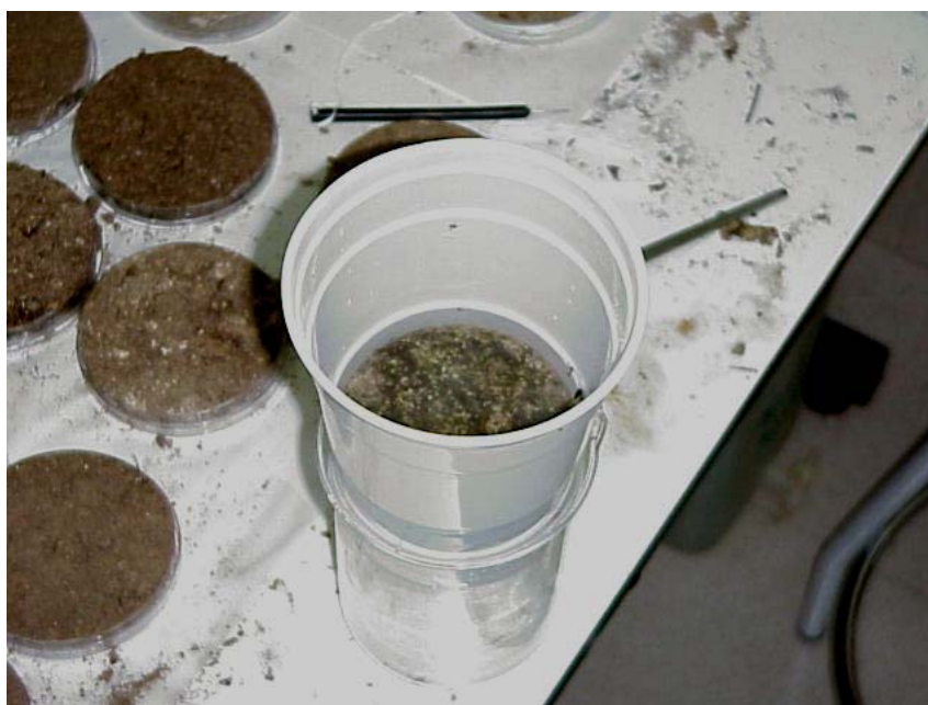
Figura 2.2. Detalle de una muestra de suelo con costra biológica a la que se está evaluando su capacidad de infiltración en el laboratorio.
