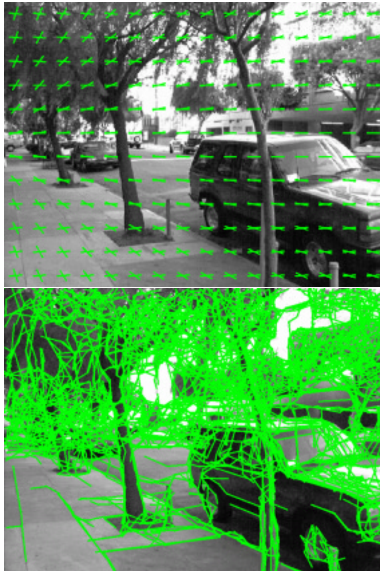
Figura 4.21: Resultados obtenidos en imágenes de exterior. El ángulo de orientación de la cámara obtenido fue de 22^\circ .
