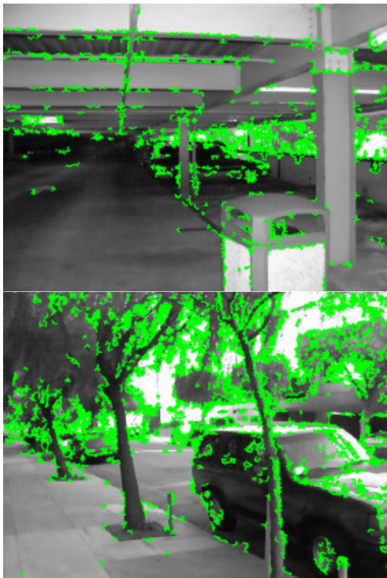
Figura 2.27: Resultado de aplicar el clasificador de uniones.
