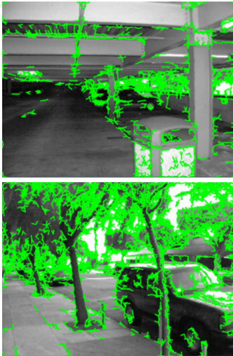
Figura 2.34: Resultado de aplicar el método de modelado de aristas.
