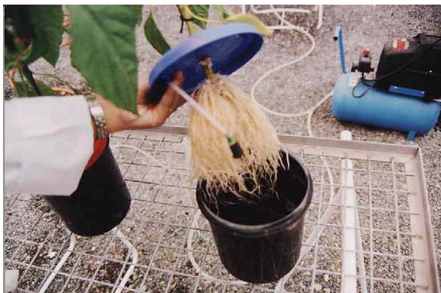
Fig.V.2. Sistema de aireación empleado para el desarrollo de la experiencia.
