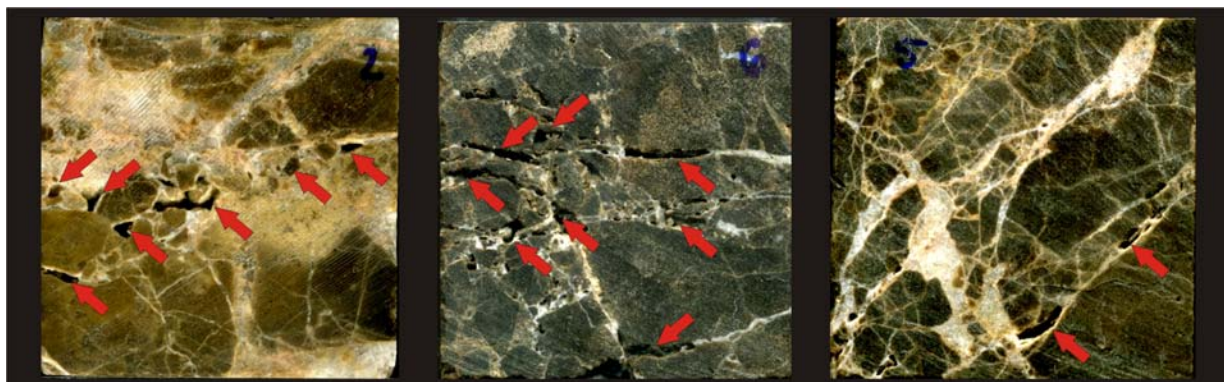
Figura 4-24: Ejemplos de cavidades asociadas a cementación parcial de vénulas en ME.
