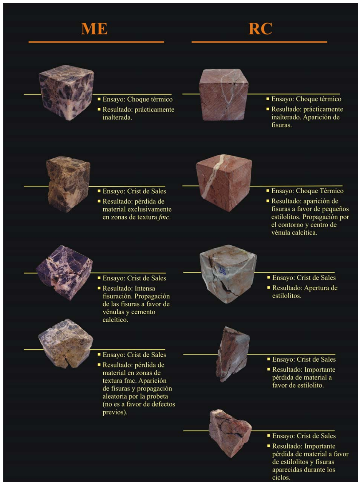
Figura 4-15: Formas de alteración observadas en las probetas de ME y RC.
