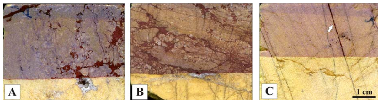
Figura 3-16: Ejemplos de la distribución de la calcita (teñida en rojo con Alizarina) en las dos subvariedades de Amarillo Triana ([A] y [B]: ATO; [C]: ATC). En ATO es común la presencia de
