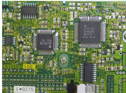
Figura 2.17: Componentes que requieren un desensamblado destructivo.
