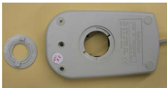
Figura 2.19: Unión de cierre mediante rosca.
