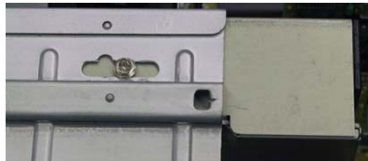
Figura 2.18: Unión de cierre generada por un tornillo.
