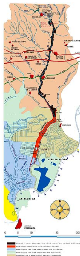
Figura1. Mapa que muestra las áreas afectadas por lodos piríticos y aguas ácidas procedentes de la rotura de la balsa de estériles del complejo minero de Aznalcóllar ocurrido en Abril de 1998. La zona de la que se han retirado y descontaminado los suelos afectados son objeto de un programa de restauración ecológica de los ecosistemas de la llanura aluvial, y la zona donde se depuraron las aguas ácidas es objeto de un programa de restauración ecológica de ecosistemas de marisma.
