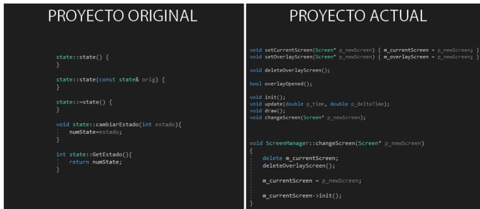
Ilustración 61 - Implementación original y actual del patrón State
