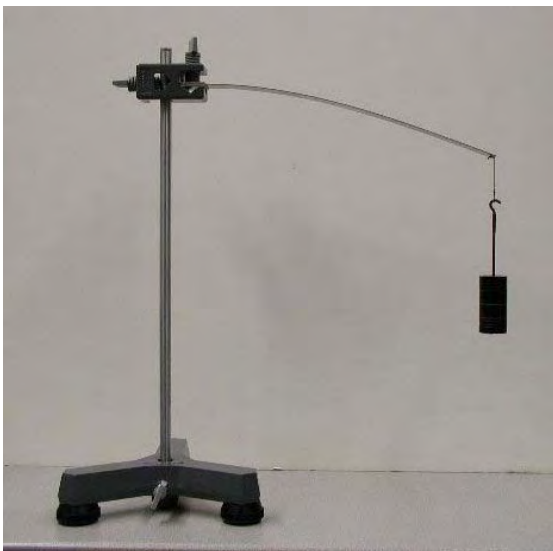
Fig. 1.- Fotografía del dispositivo experimental (regla de acero en voladizo) analizado.
