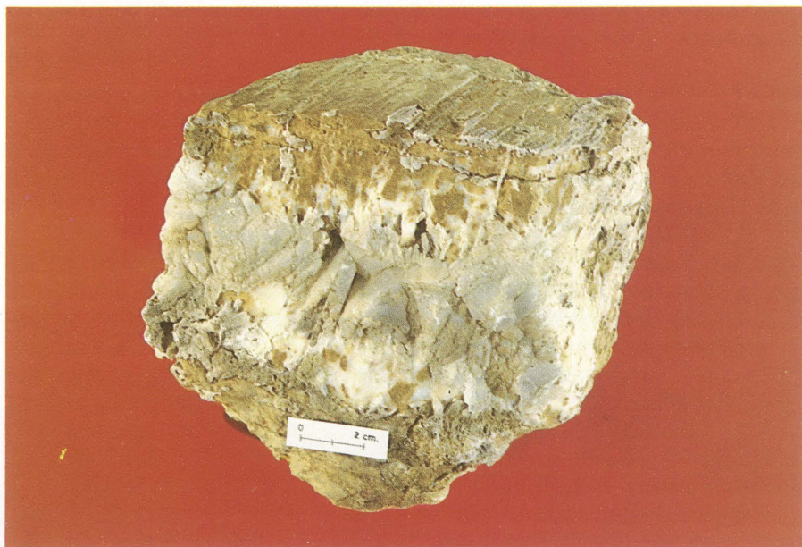
Fig. 1 B. — Tipo 2, celestina "en bocadillo" limitada a ambos lados por calcita; en contacto con la roca de caja se desarrolla un crecimiento previo de fibras de ambos minerales.
