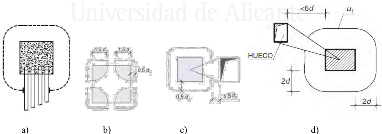
Fig. 11. Zona a excluir del perímetro crítico a la hora de calcular: a) 7.3-23 MC2010, b) 7.3-24a MC2010, c) 7.3-24b MC2010, y d) EHE-08 fig 46.2.e
