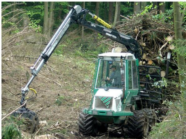
**Figura 3.** Tractor autocargador concentrando los residuos forestales
