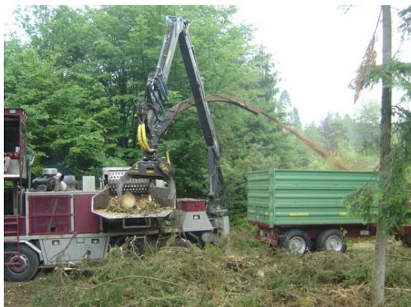
**Figura 4.** Astilladora transportable astillando residuos forestales.
