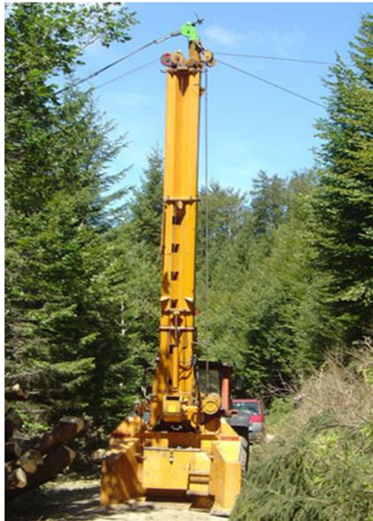
**Figura 5.** Torre de extendido de cable aéreo
