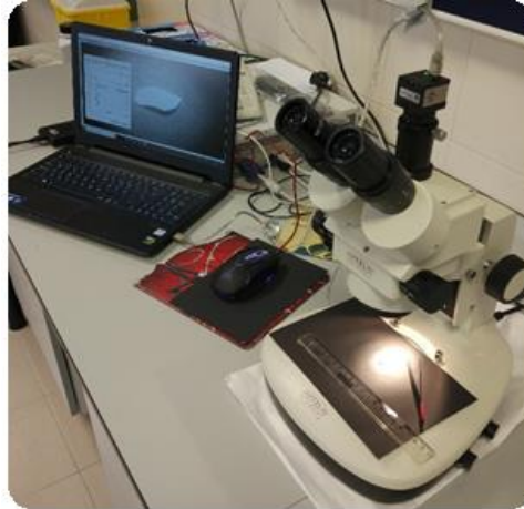
Figura8: Entorno de trabajo. A la derecha, selección y posicionamiento del otolito en la lupa. A la izquierda, control del perfil y software de imagen UEyeCockpit.
