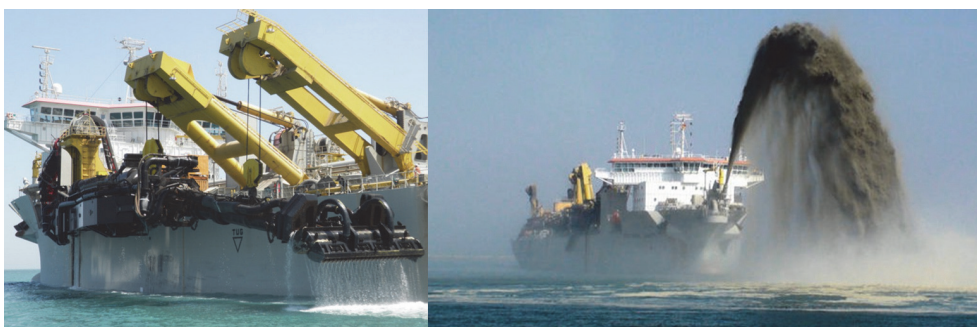
Fig. 1. A la izquierda, vista general de la tubería de succión (en negro) y de los pórticos de maniobra (en amarillo) de la Cristóbal Colón. A la derecha, descargando por proa
