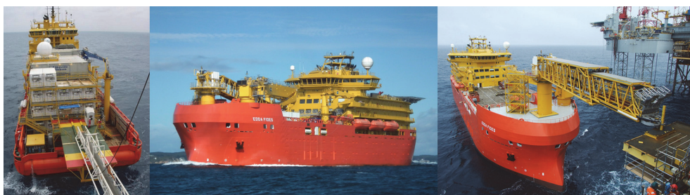
Fig. 11. A la izquierda, el Edda Fjord, adaptado con módulos habitacionales para ser transformado en flotel. En el centro y a la derecha, el Edda Fides
