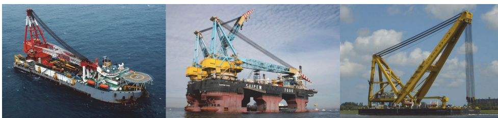
Fig. 6. Distintos buques de izado empleados para la construcción de parques eólicos
