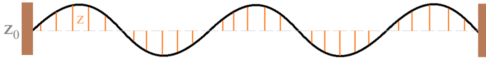
Figura 7.16: Visualización del concepto rugosidad para una membrana prístina previa al proceso de irradiación y sujeta a una deformación inicial determinada. Vista lateral de la membrana. z_0 muestra la posición inicial de la membrana plana (línea gris horizontal), antes de la relajación inicial y z (línea naranja vertical) muestra la posición de cada átomo que se tomaría en el cálculo de la rugosidad. En este caso en el que sólo se ha aplicado una deformación (tracción o compresión) a la muestra correspondería con su amplitud al cuadrado.
