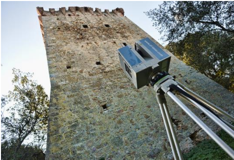
Fig. 3- Lo scanner al lavoro attorno a Torre Bassa (G. Verdiani, 2017)
