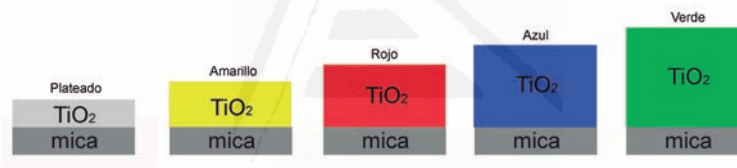
Figura 2.13: Dependencia del color de interferencia con respecto al espesor de la capa de dióxido de titanio.
