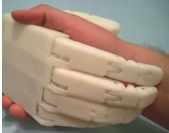
Figura 12: Mano robótica controlada usando señales EMG. Fuente: (Torres San Miguel, Velásquez Sánchez, González Lugo, & Tapia Herrera, 2011)
