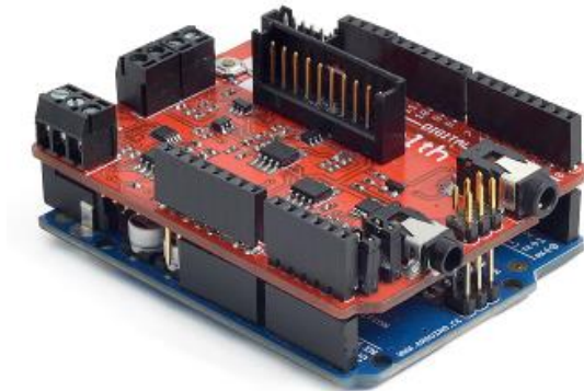
Figura 18: Montaje de e-Health sobre Arduino UNO. Fuente: (Cooking Hacks, 2017)
