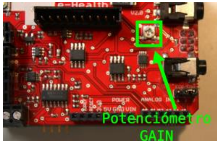
Figura 26: Ubicación del potenciómetro en la tarjeta e-Health. Fuente: (Robologs, 2016)
