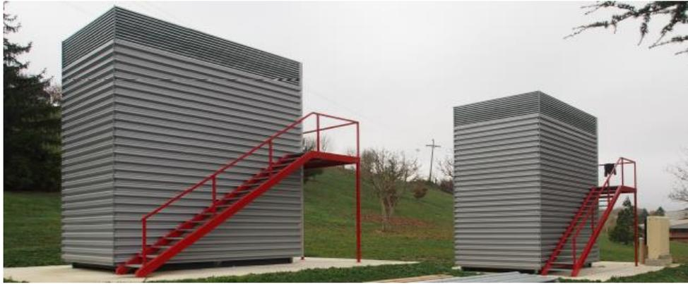
Figura 31. Fotografía de los dos prototipos de ensayo. Prototipo FV sin control (derecha) y prototipo FV con sistema de climatización termoeléctrica (izquierda). Fuente: DADUN. Depósito académico digital Universidad de Navarra.
