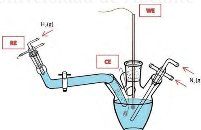
Figura 2.1. Esquema de la configuración de celda electroquímica de 3 electrodos.
