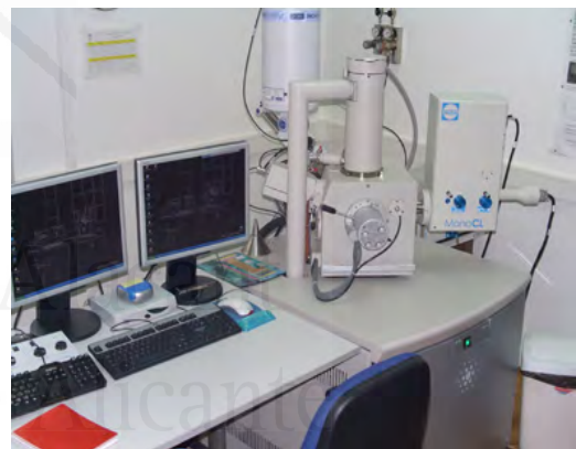
FIGURA 2.4. Microscopio electrónico de barrido FEI INSPECT con detector de catodoluminiscencia del Servicio de Técnicas no destructivas del MNCN.
