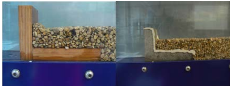
Figura 9 Topes para impedir la fuga de material hacia la bomba de madera y mortero respectivamente. (Imagen propia)
