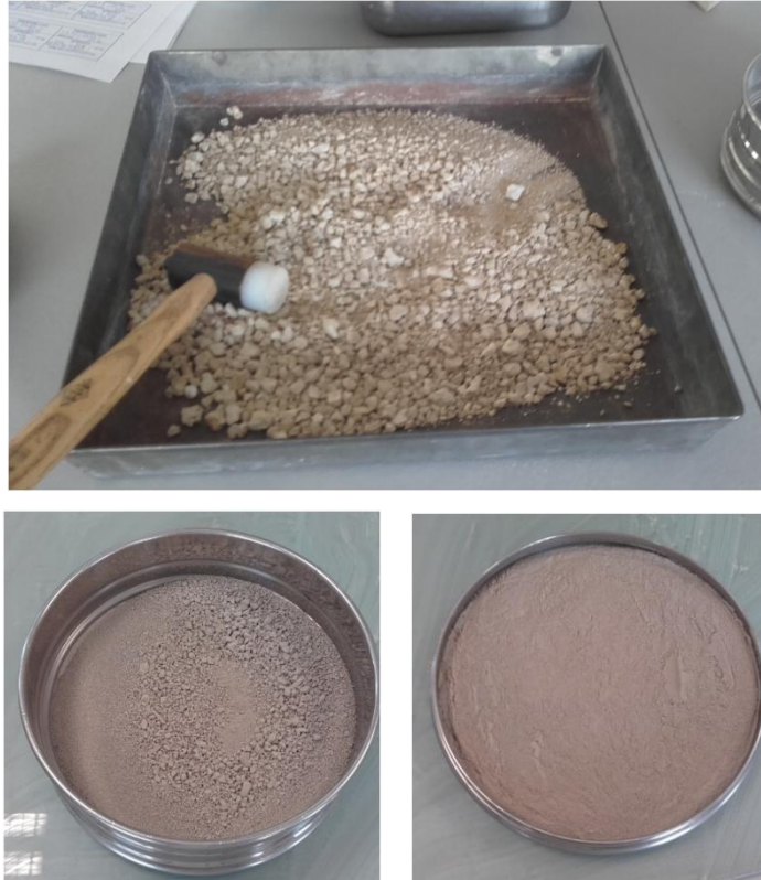
Figura 49. Obtención de la fracción de suelo que pasa por el tamiz 400 \mu m.
