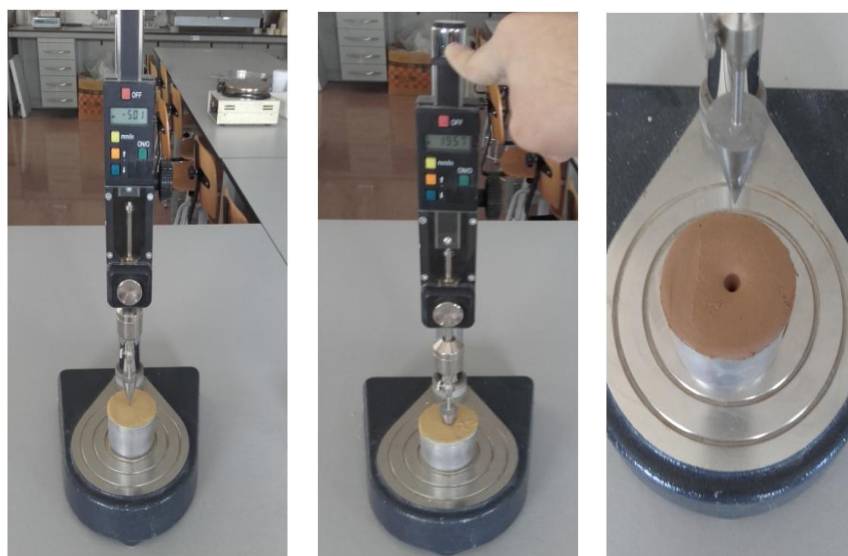
Figura 47. Antes y después de la penetración del cono.
