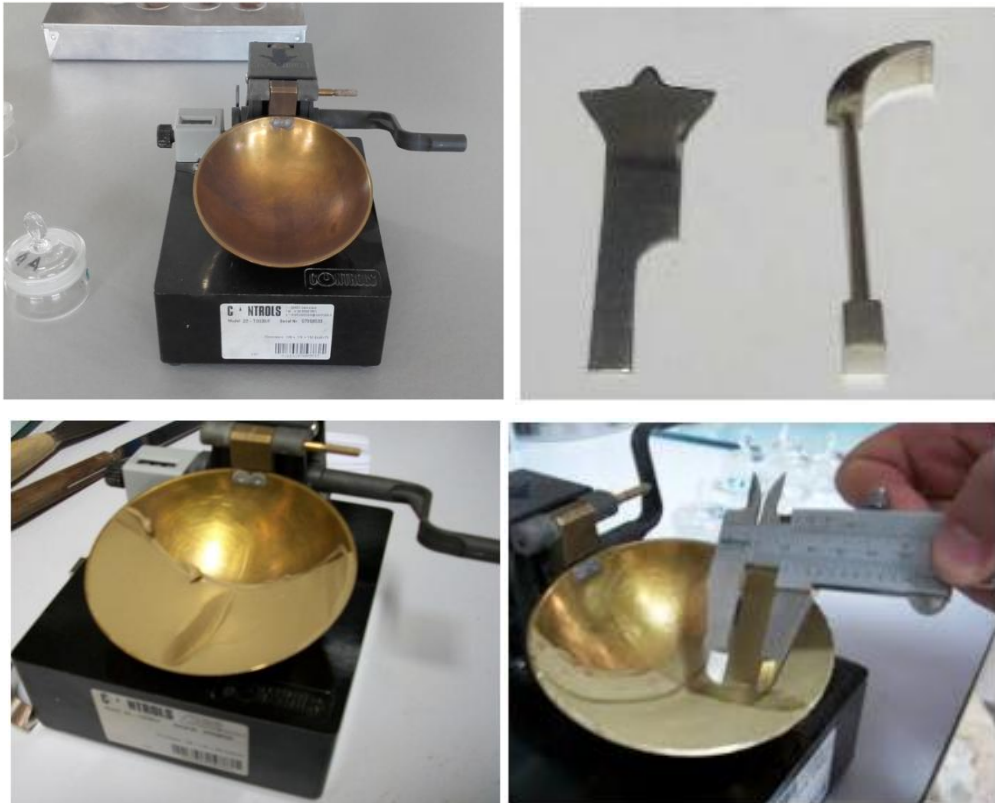
Figura 51. Colocación de la muestra sobre la cuchara y resultado tras ejecutar los golpes.
