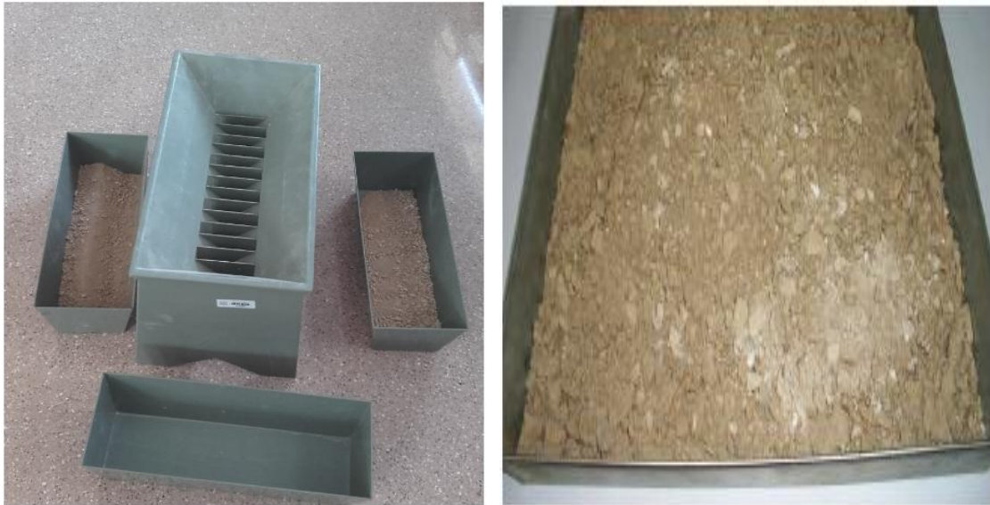
Figura 42. Preparación previa de las muestras: cuarteo y secado al aire o con estufa a 60°.
