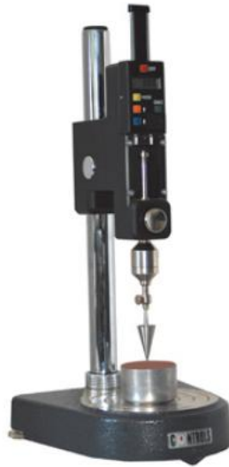
Figura 29. Penetrómetro cónico moderno (Empresa Controls).
