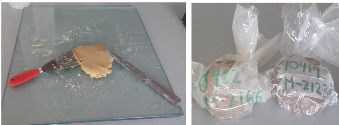
Figura 50. Amasado y curado de las muestras de suelo.
