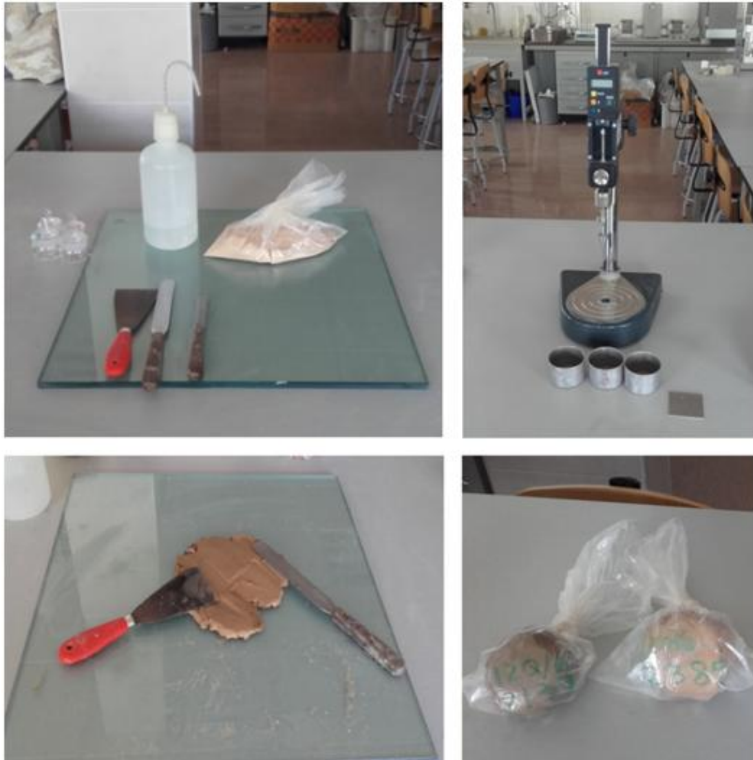
Figura 45. Amasado y reposo de las muestras de suelo.
