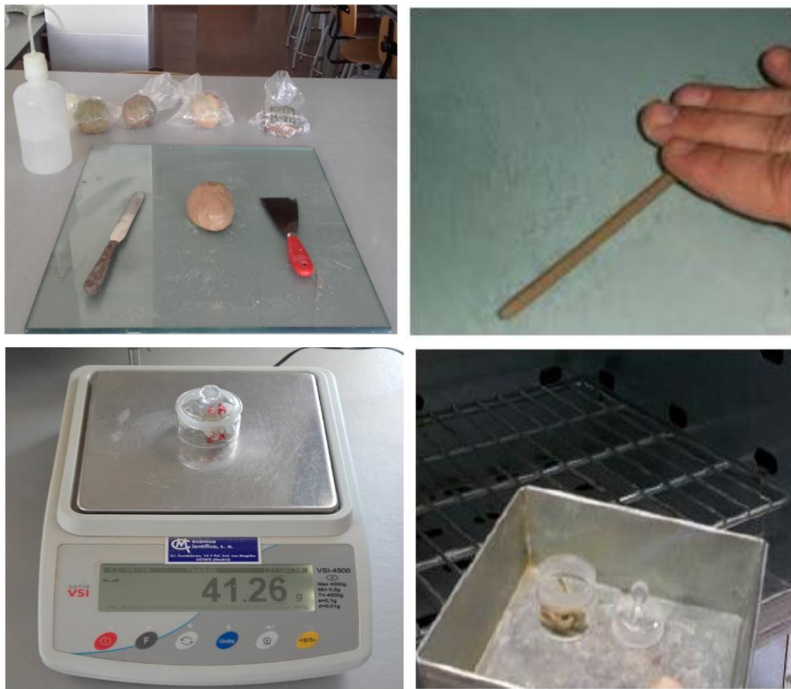
Figura 52. Determinación del límite plástico.
