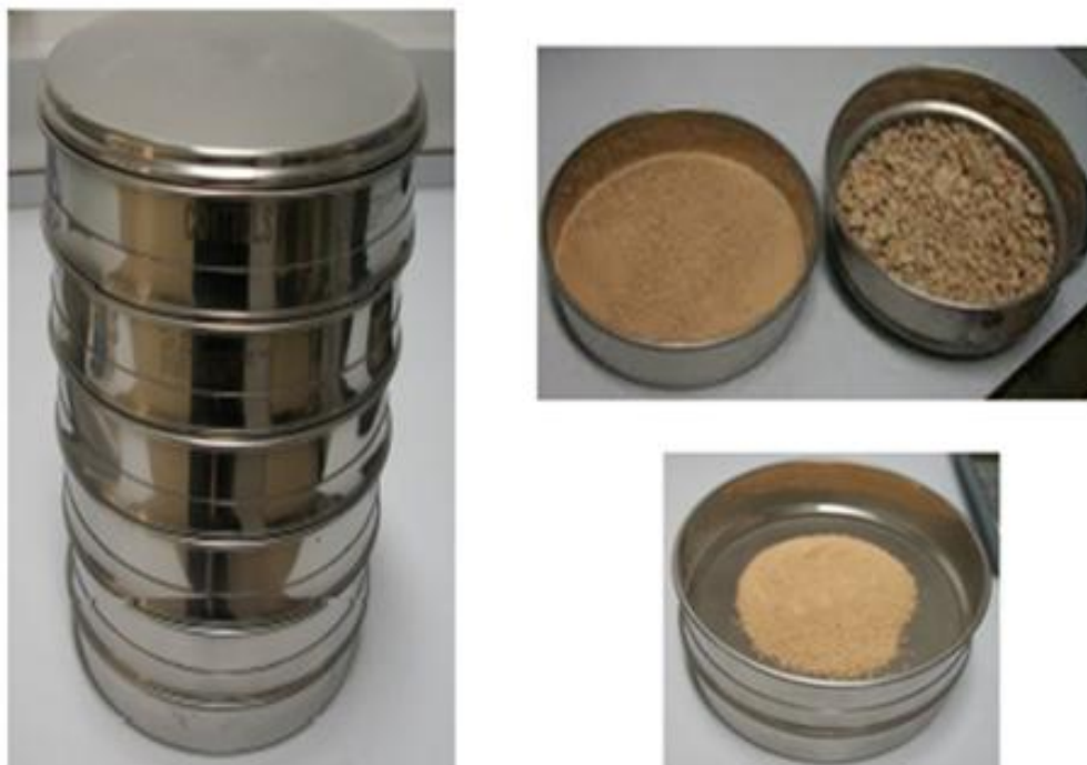
Figura 43. Material utilizado para el análisis granulométrico.
