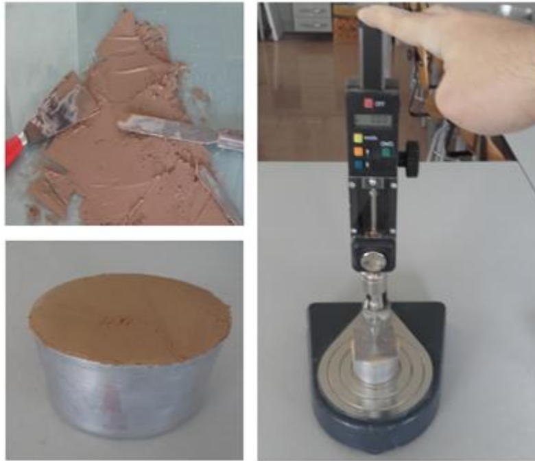
Figura 46. Colocación de la muestra en el recipiente y calibración del penetrómetro.
