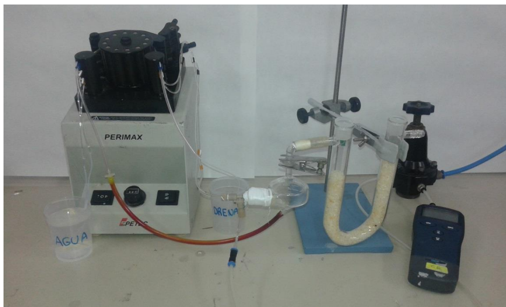
Figura 9: Dispositivo experimental utilizado para determinar el transporte de disolvente.
