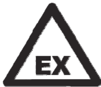
Figura 2. Señalización para zonas de riesgo de atmósferas explosivas. Fuente: RD 681/2003.
