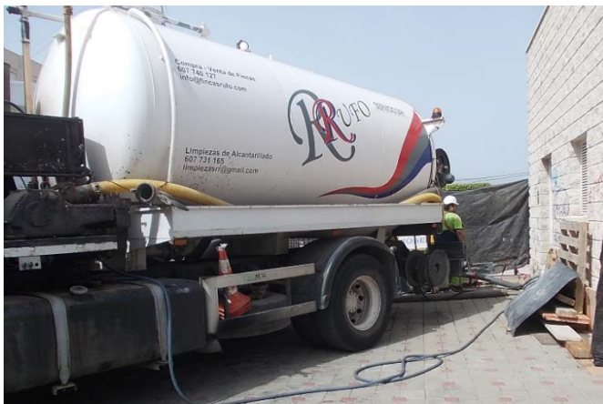
Figura 30 (Izq). Cuba extractora. Fuente: Autor. Figura 31 (der). Operario con EPI. Fuente: Autor
