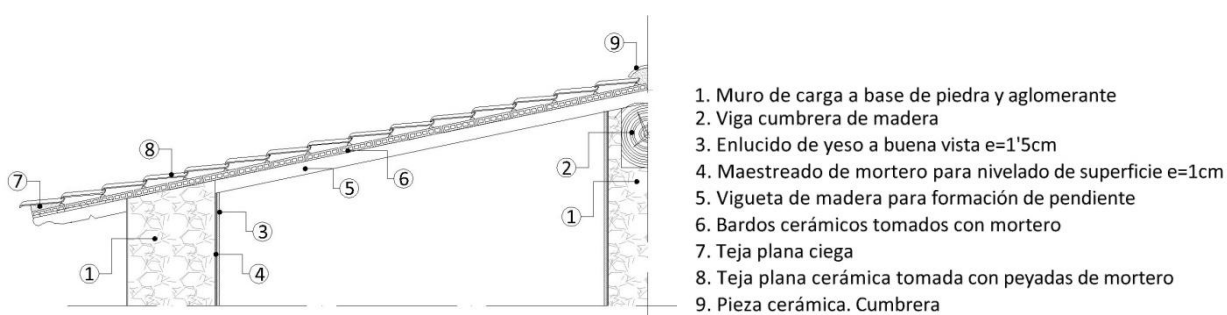
Figura 83: Sección cubierta inclinada
