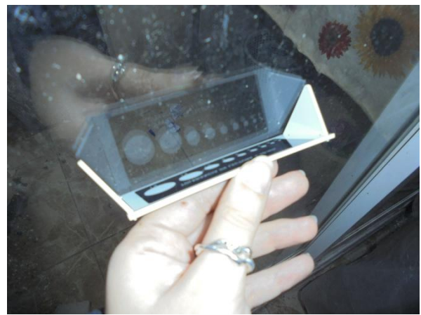
Figura 93: Uso del medidor óptico en vidrio simple (Fuente: Autora)
