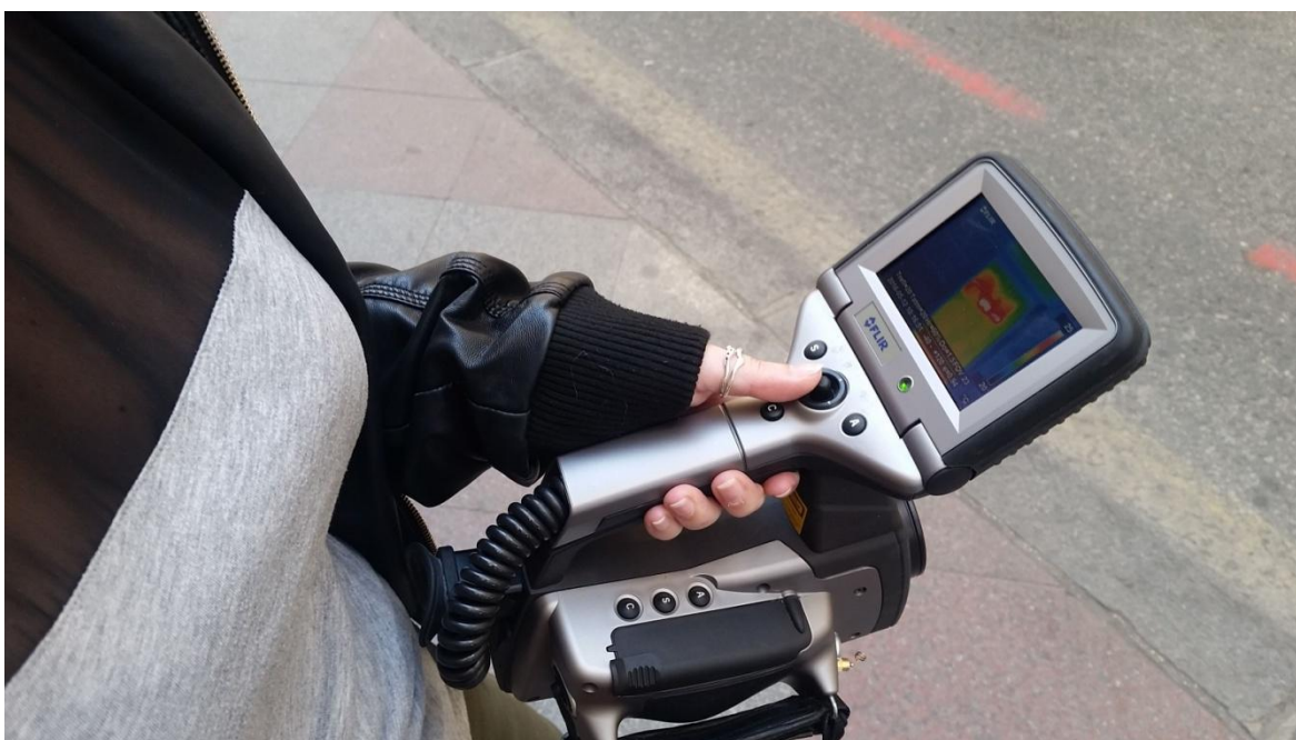
Figura 7: Uso de la cámara termográfica durante el estudio
