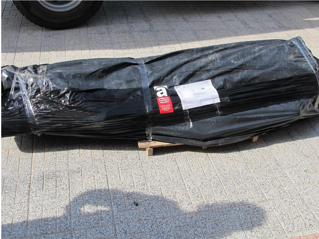
Figura 58. Residuos macroencapsulados, etiquetados y preparados para transporte.
