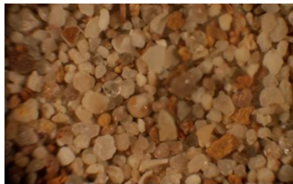
Figura 8. Arriba: fotografía de levigados (fracción 125 micras, materiales de la Cuenca del Bajo Segura); abajo: arenas (playa de Rodas, islas Cíes). Imágenes tomadas con el dispositivo cámara IDS, modelo Ueye – lupa binocular LFZ
