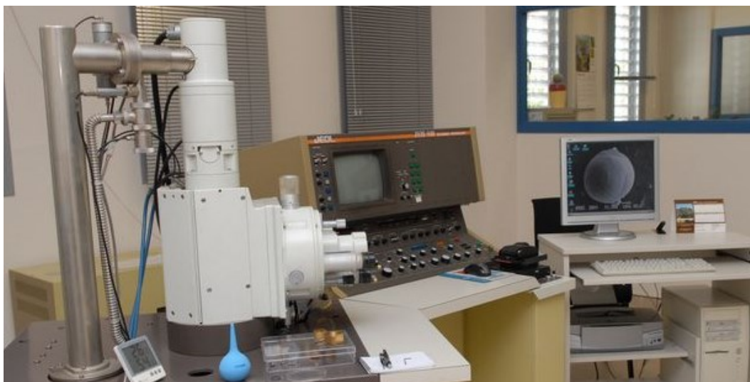
Figura 2. Microscopio Electrónico de Barrido (JEOL modelo JSM-84) empleado para adquisición de fotografías de microfósiles ilustradas en esta memoria
