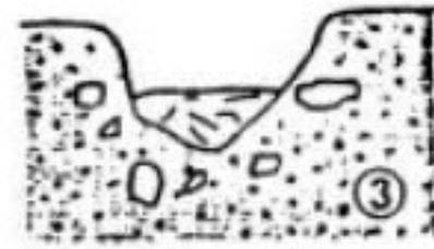
Formation d'un "cratère" par éclatement de G et du mortier de recouvrement
