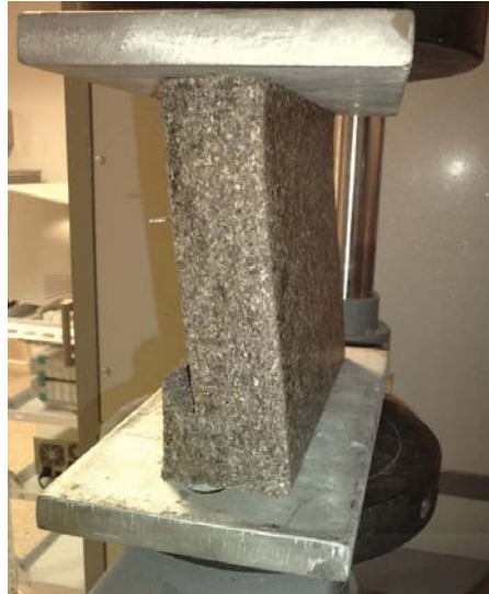
Foto 6.4.6. Ensayo a compresión en el plano del tablero. Tensión de rotura
