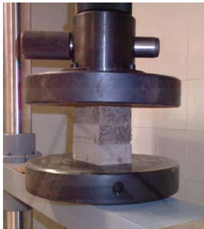
Figura 6.4.13. Ensayo a compresión en el espesor. Tablero de posidonia
