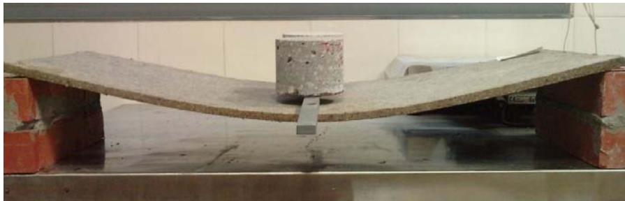
Figura 6.4.20. Ensayo a flexión. Tablero de posidonia.
