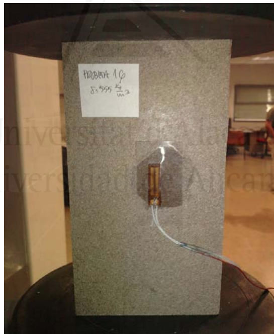
Figura 6.4.10. Ensayo a compresión en el plano del tablero. Deformaciones por extensometría.
