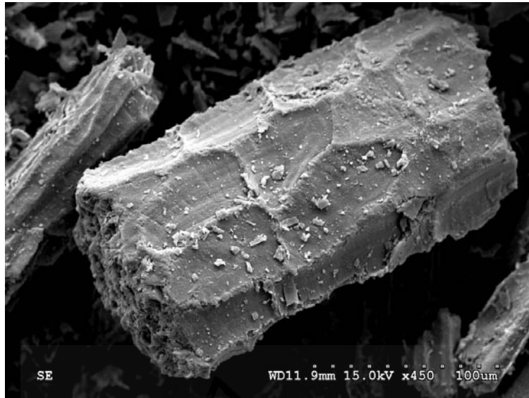
Figura 6.2.5. Residuo de posidonia natural triturada lavada a 450 aumentos
