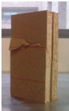
Figura 6.4.7. Marcas de referencia para la lectura de las deformaciones, l_1 = 75 mm.
