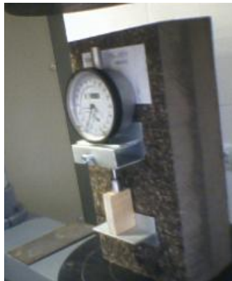
Figura 6.4.9. Aplicación del dispositivo de medida de deformaciones.
