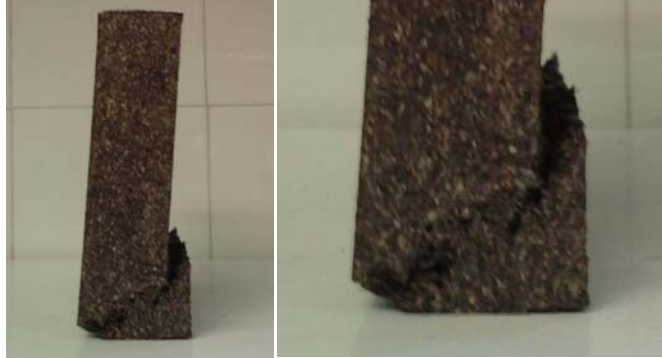
Figura 8.1.8. Ensayo a compresión en el plano del tablero. Fallo en los bordes
