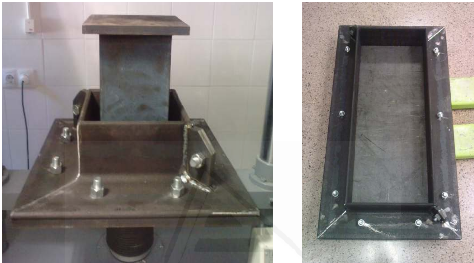
Figura 6.3.10. (Izquierda) Molde de 200x200x120 mm de acero S275. (Derecha) Molde de 780x300x120 mm de acero S275
