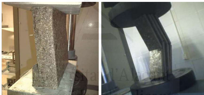
Figura 8.1.5. Ensayo a compresión en el plano del tablero. Rotura en el apoyo (izq.); Rotura por pandeo (dcha.)
