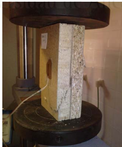
Foto 8.1.7. Ensayo a compresión en el plano del tablero. Rotura por corte a 45°.
