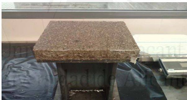
Figura 6.3.12. Desmolde de las probetas. Incrustaciones de parafina
