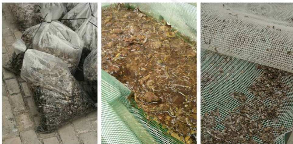
Figuras 6.3.3, 6.3.4 y 6.3.5 Acopio de Posidonia oceánica de la playa + Limpieza de restos de sal y otras materias orgánicas e inorgánicas + Secado a temperatura ambiente de la posidonia oceánica limpia de restos de sal y otras materias
