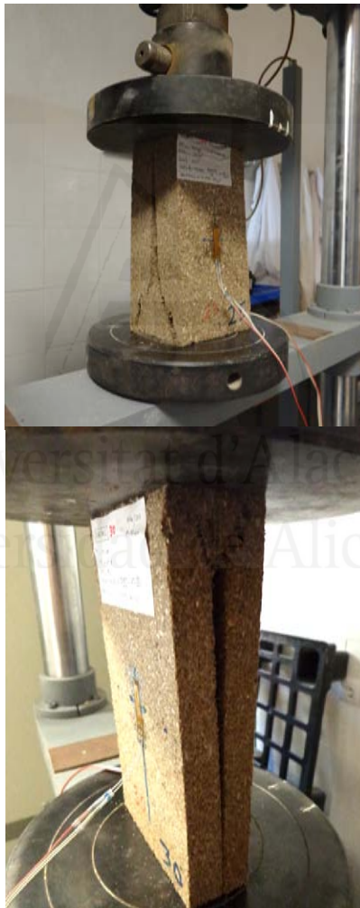
Foto 8.2.1. Tipo de rotura 1: fallo completo de un apoyo.
