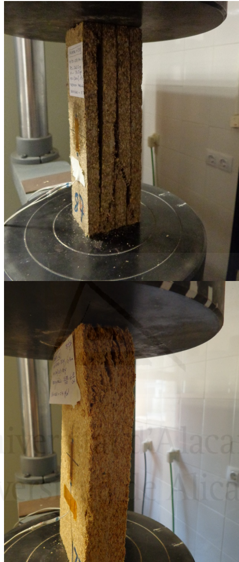
Foto 8.2.4. Tipo de rotura 2: fallo en láminas: (izq.) fallos a distinta altura en cada lámina; (dcha.) fallo por delaminación en zona próxima al apoyo
