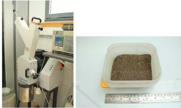
Figura 6.3.6. Molino del laboratorio de materiales del Departamento de Ingeniería Civil y hoja de posidonia oceánica después del proceso de molido.
