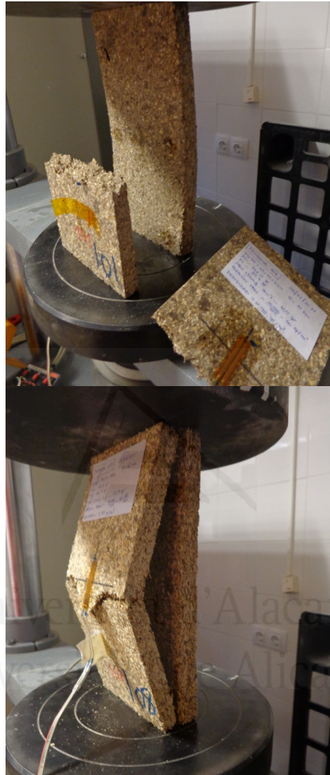
Foto 8.2.6. Tipo de rotura 3: inestabilidad, pandeo y rotura de una lámina del panel.
