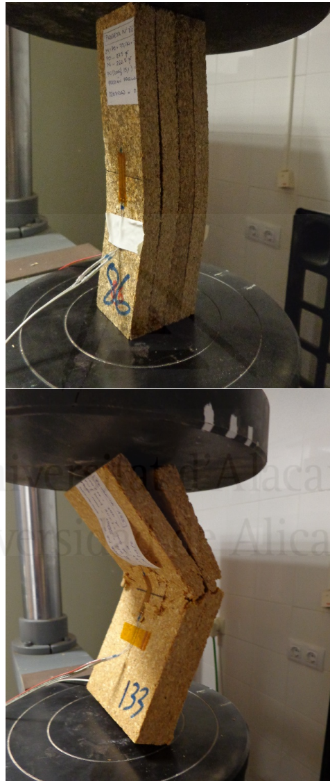
Foto 8.2.5. Tipo de rotura 3: inestabilidad global, pandeo.
