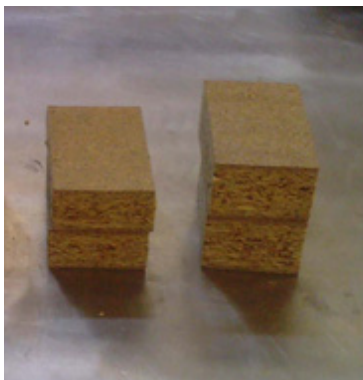
Figura 6.4.16. Ensayo a compresión en el espesor. Tablero de partículas de madera. Deformación
