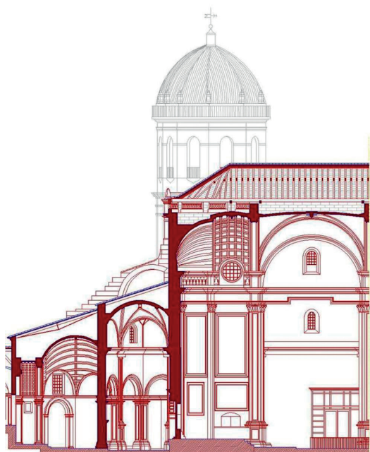
Figura 6. Colegiata San Patricio en Lorca. Plano de detalle de sección longitudinal editado tras inspeccionar el espacio bajo cubierta durante las obras de restauración tras el sismo de 2011.
