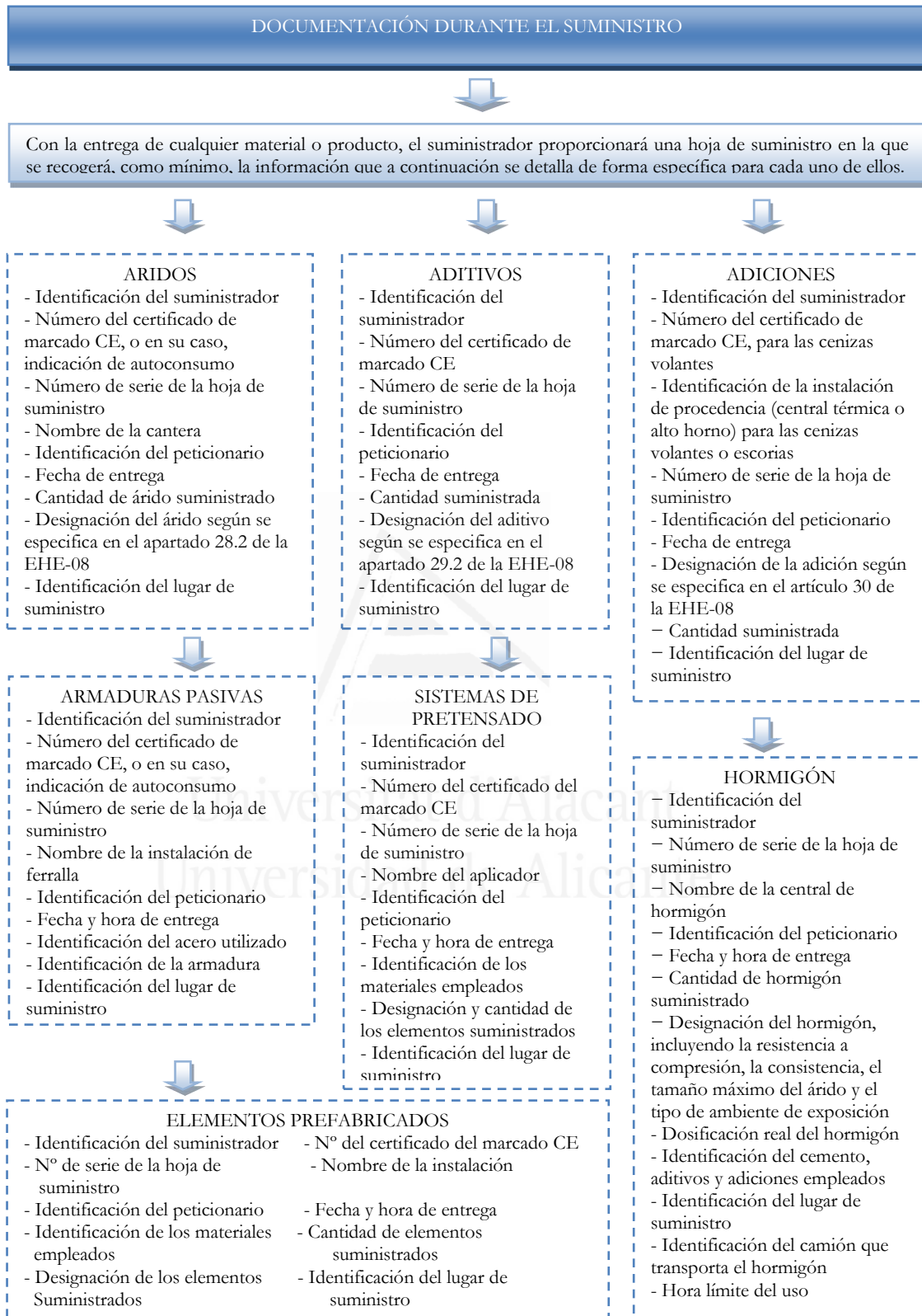
Cuadro 2. Documentación durante al suministro Fuente: Elaboración propia
